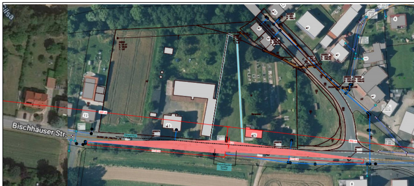
Abb. 5 Darstellung des Sichtdreiecks für eine Geschwindigkeit von 70 km/h.
